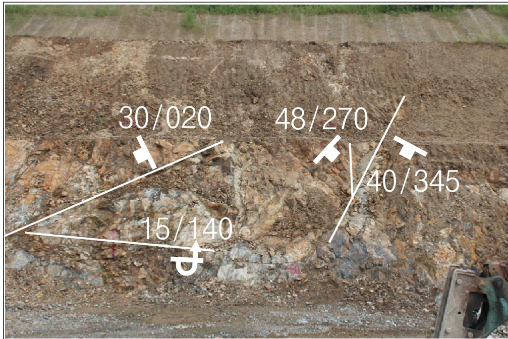
【그림 12】 A 영역에 발달한 불연속면
