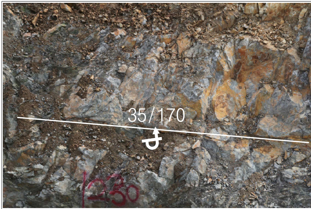
【그림 29】 C 영역에 발달한 불연속면
