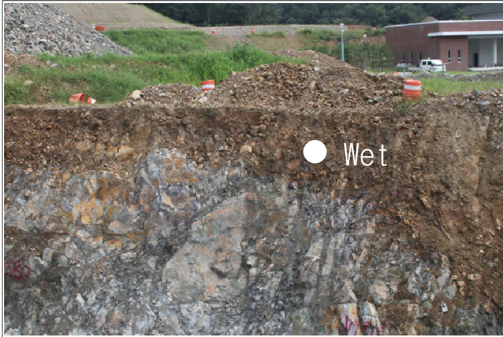
【그림 31】 C 영역 상세사진 (지하수 유출)
