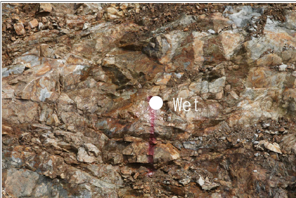
【그림 17】 A 영역 상세사진 (지하수 유출)
